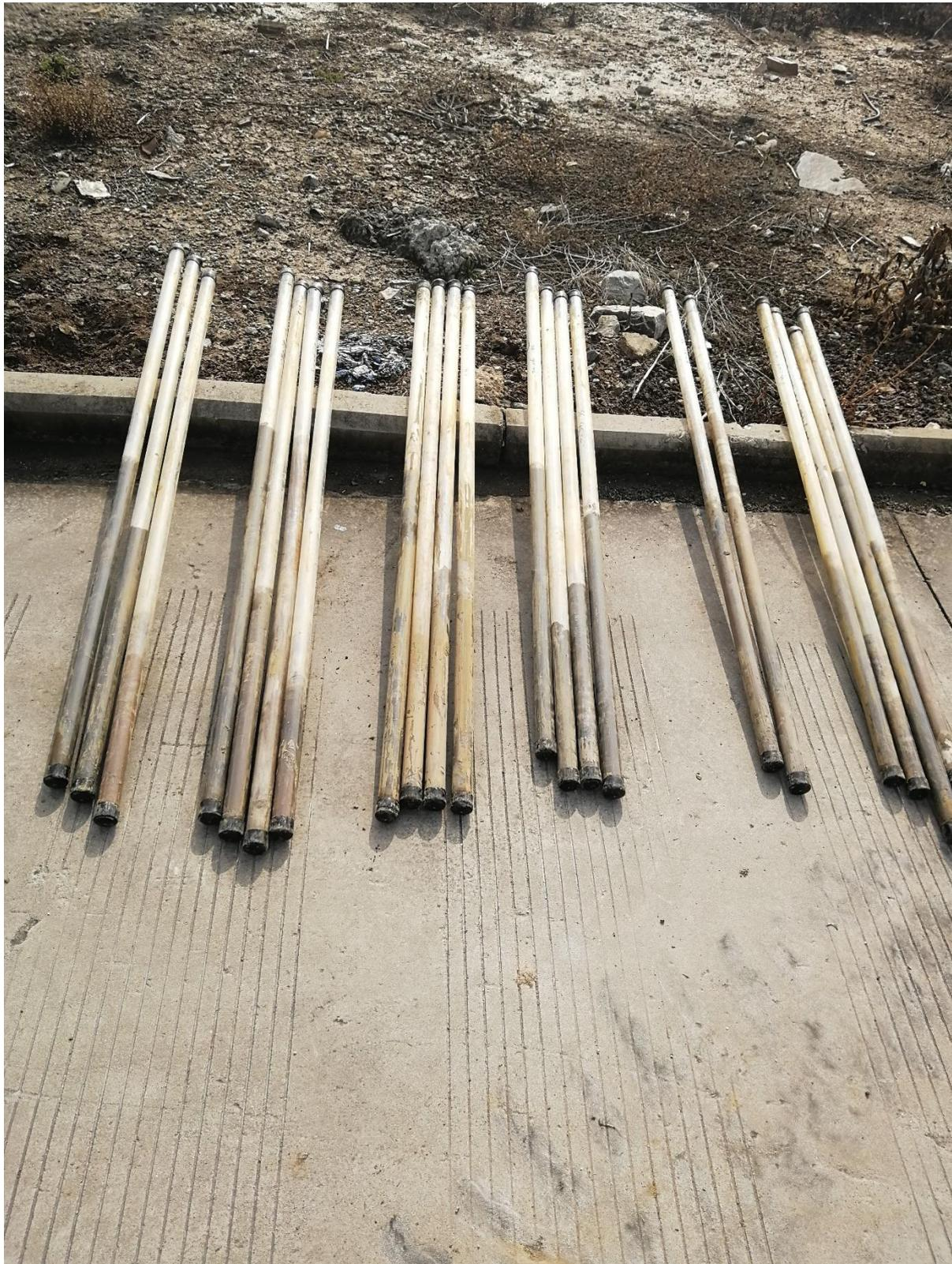
图 5.2-3 Geoprobe 采集土壤样品
