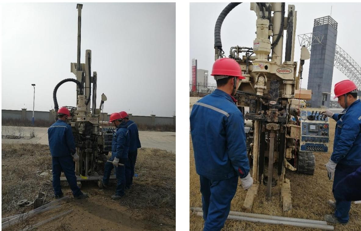
图 5.2-2 Geoprobe 土壤采样设备
