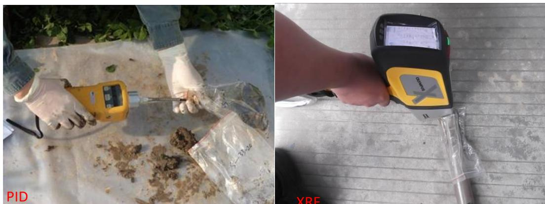
图 5.2-4 现场快速检测设备
