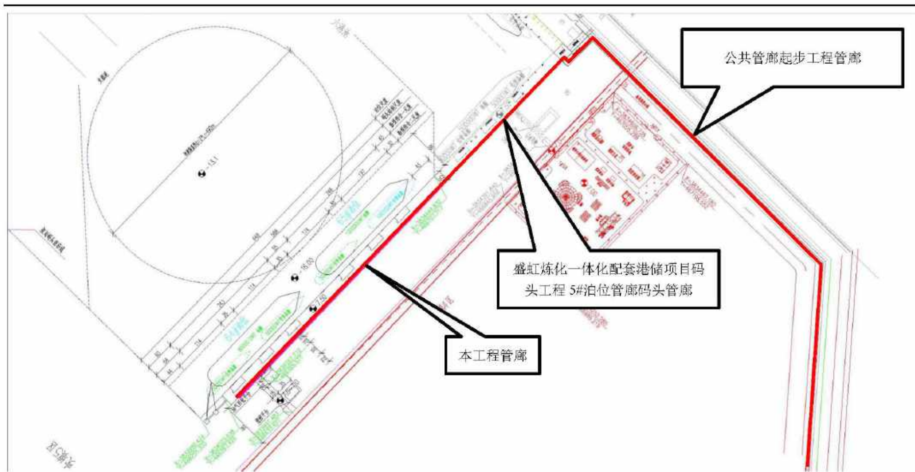
图 3.3-3 本项目码头和依托盛虹炼化一体化配套港储项目码头工程 5#泊位管廊码头管廊
