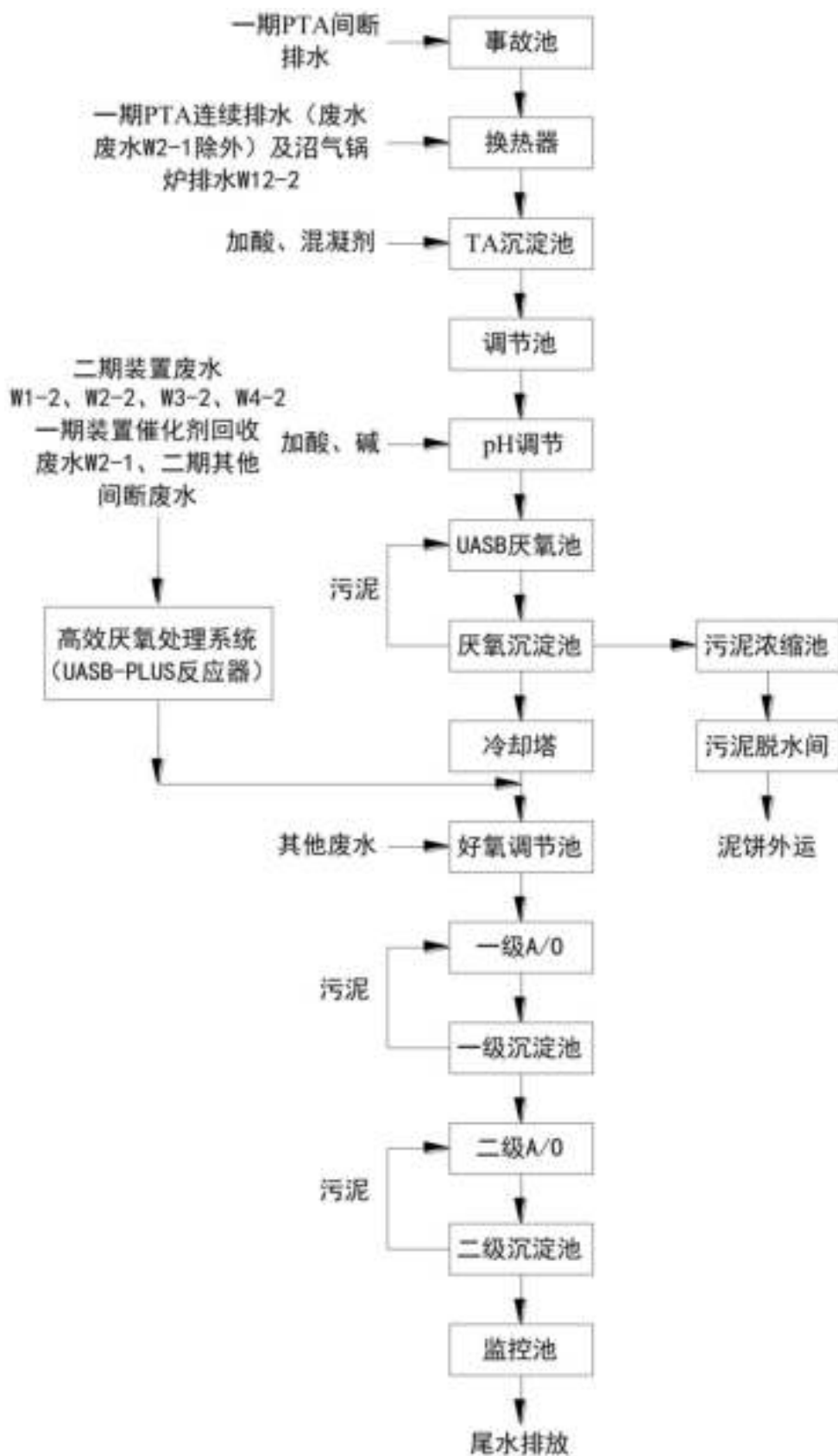
图 3.1-3 废水处理工艺流程及产污环节图
