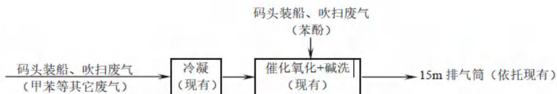
图 3.2-2 新荣泰码头废气处理流程图
