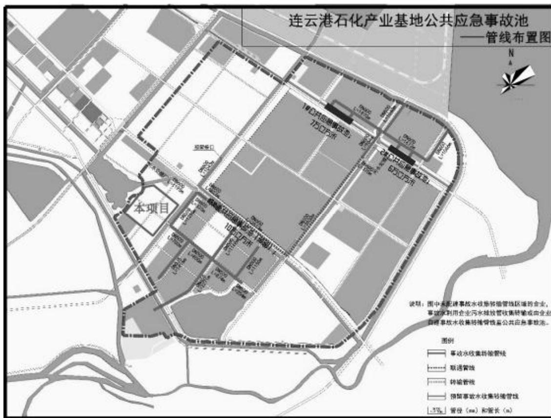
图 6.2.6-6 石化基地公共应急事故池管线布置图
