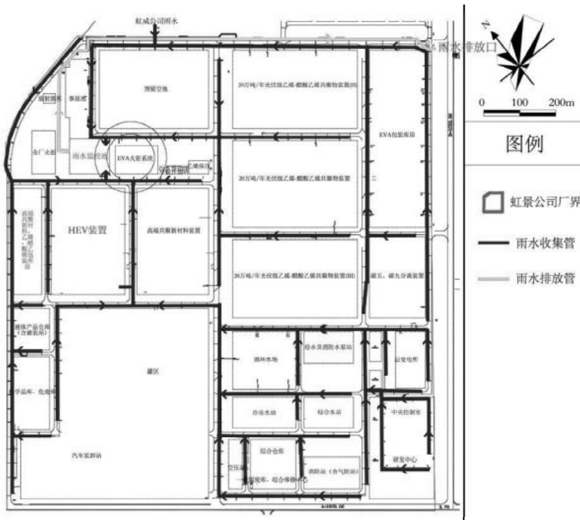
图 6.2.6-1 虹景公司雨水管线走向图
